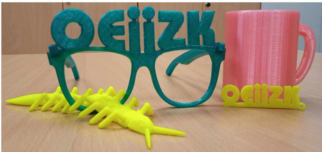
Rysunek 11. Przykładowe wydruki 3D z filamentu ABS (kolor żółty) oraz PLA (kolory zielony i czerwony)
